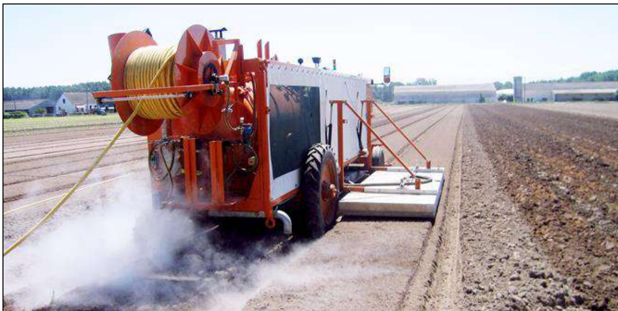
Figure 5 : Exemple d'engin utilisé pour désinfecter les sols à la vapeur
