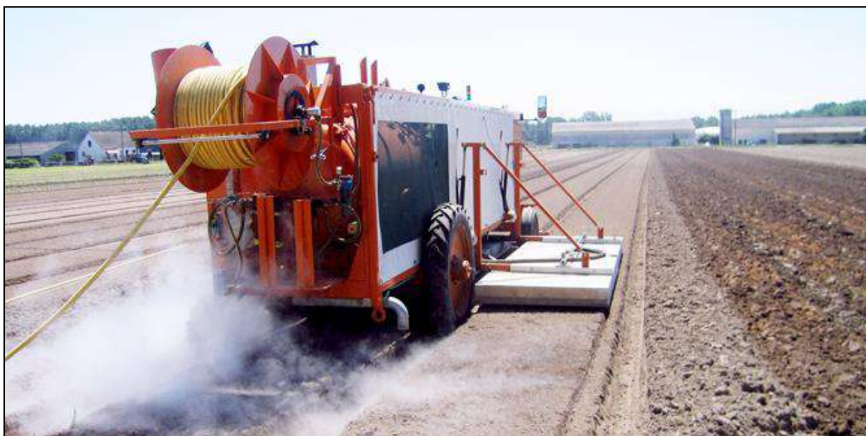
Figure 8 : Exemple d'engin utilisé pour désinfecter les sols à la vapeur
